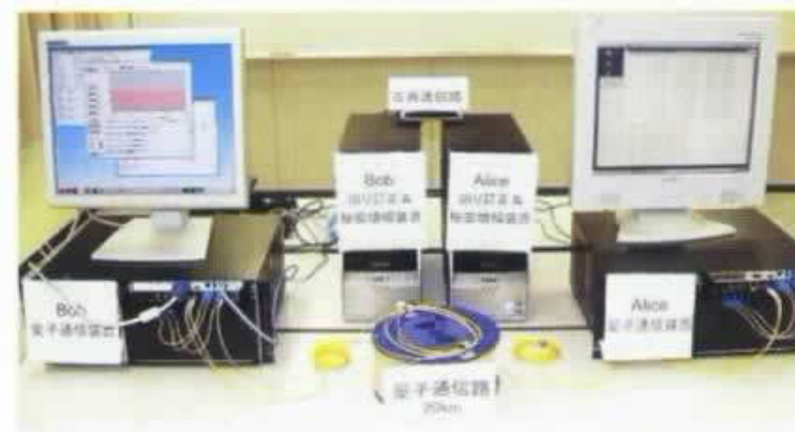
量子暗号システムによる量子暗号鍵配布実験
