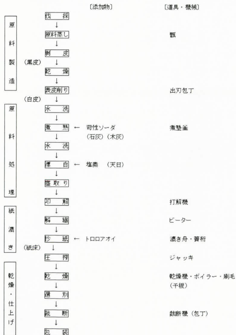
図9 手漉き和紙の製造工程と主な機械・道具
