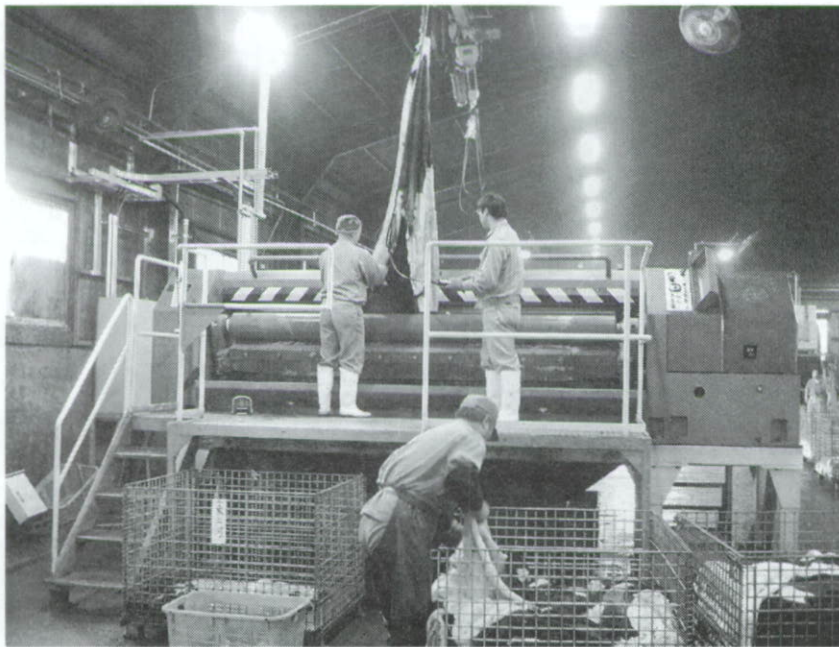
写真3. 3 フレッシングマシンに牛皮を入れるところ
