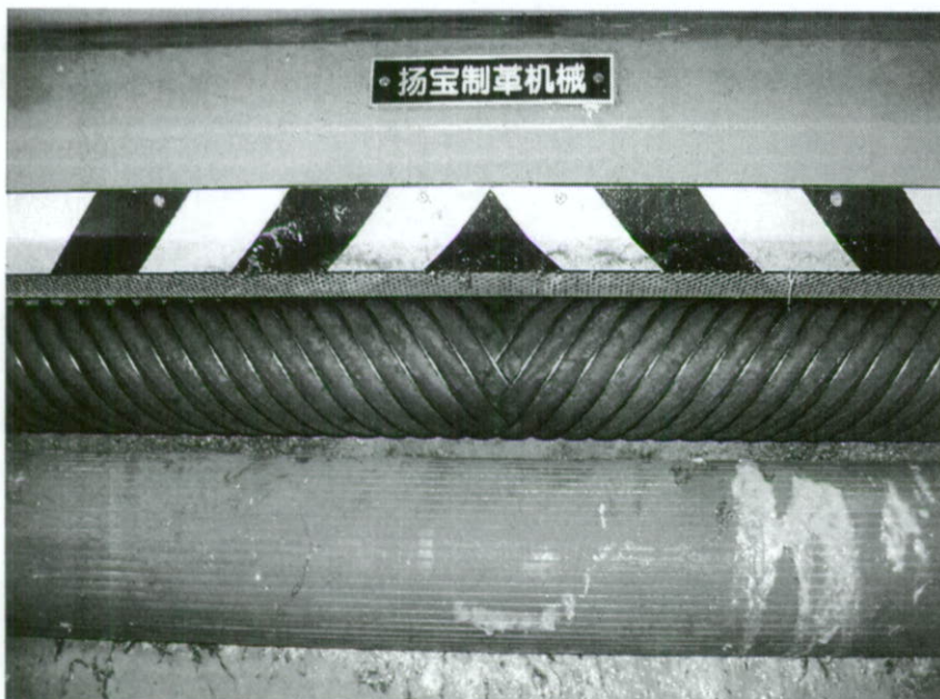
写真2. 5 刃ロールとゴムロール
