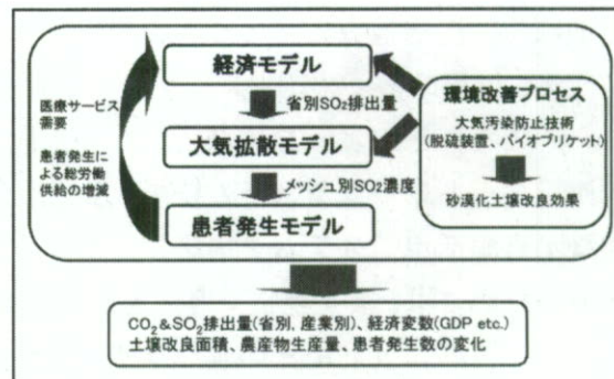
図5：脱硫プロセス導入時の統合評価基盤
