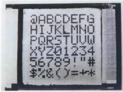
Te TFTを用いた50mm×50mm、50×50ドットのアクティブマトリクスLCD(1982) 通産省補助金・試験研究事業 「TFTを用いた大容量XYマトリクス型液晶表示に関する応用研究(初年度)」
