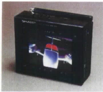
7.6cm(3型)384×240ドットのa-Si TFT-LCDを用いた 小型液晶テレビ(エレロニクショーB6Iに出展・好評) 商品化は1987年
