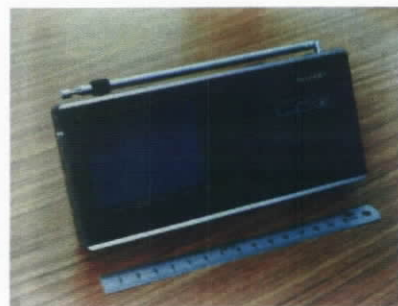
8.1cm(3.2型)a-Si TFT-LCDを用いたポケットブル液晶テレビ試作品 (1985)
