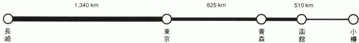
図1 日本列島縦貫電信線架設状況(明治7年末)
