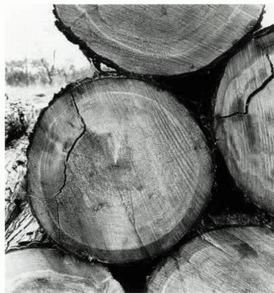
▶台風被害木断面のき裂(能登にて)
