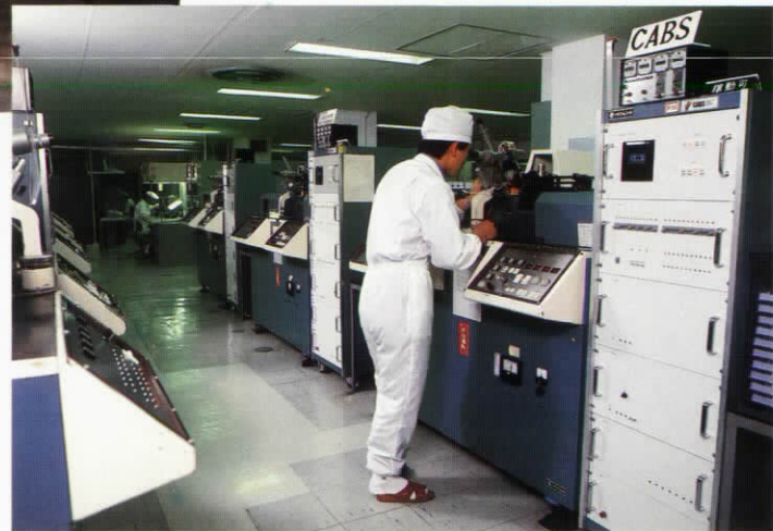
視覚機能をもつ自動ワイヤボンディングロボット 日立製作所武蔵工場
